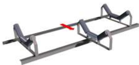
Demontaż istniejącego zestawu
