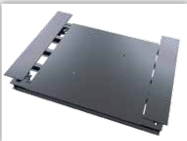
Waga pomostowa R4+, pomost 3-częściowy, Wymiary: od 1 500 x 1 500 mm do 2 000 x 1 500 mm Nośność: od 1 500 do 6 000 kg Wytrzymałość mechaniczna: od 6 do 10 ton
